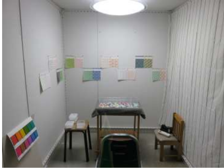
ภาพที่ 8. ลักษณะห้องทดลอง และแหล่งแสง ที่ปรับความสว่างและปรับอุณหภูมิสีได้
